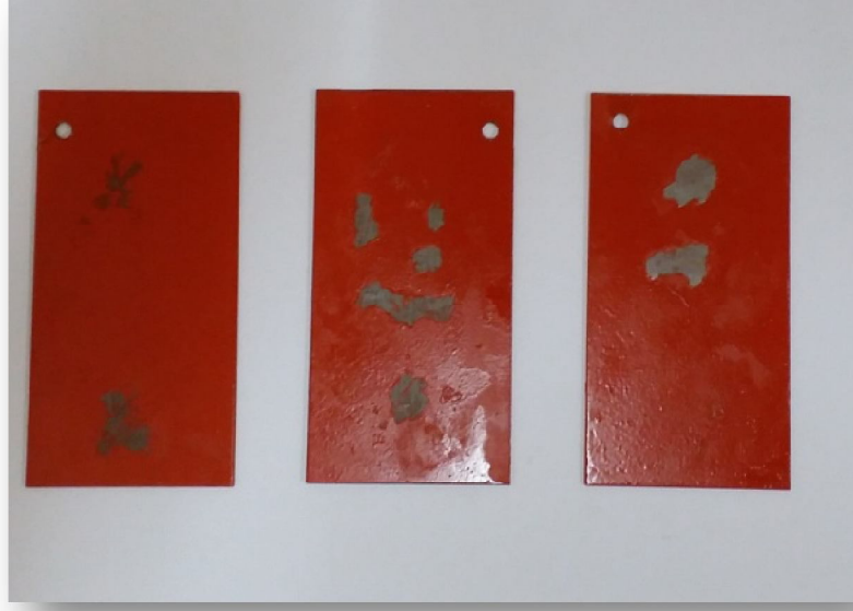
شكل رقم (٥) نتيجة اختبار قوة التصاق طبقة الطلاء في العينات المجهزة بالطريقة التقليدية
